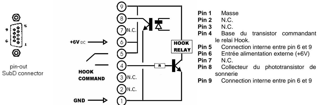
L'interface de BoxTel a été conçue pour une connection directe avec les modules **TELCO** des consoles **Oxygen 4 Oxygen 5 et Oxygen 7** d'**Axel Technology**. Dans ce cas il suffit d'utiliser un câble RS232 droit à 9 fils entre le module Telco et BoxTel
