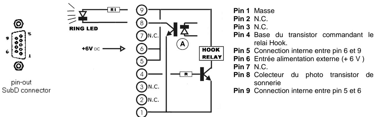
Une LED externe (Ring Led sur le schéma ci dessus) peut être reliée entre 8 et 9 via une resistance de 470Ohm (voir R1) pin 6 doit être alimentée par du +6V continu. Cette led s'allumera à chaque sonnerie.
